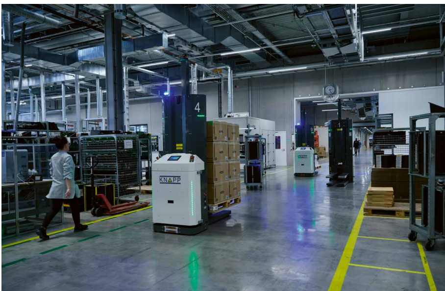
▶ 16 Open Shuttle Fork übernehmen bei Fronius Transporte aller Art. Sie transportieren Ladegüter wie Europaletten, Kunststoffpaletten und Müllcontainer.
