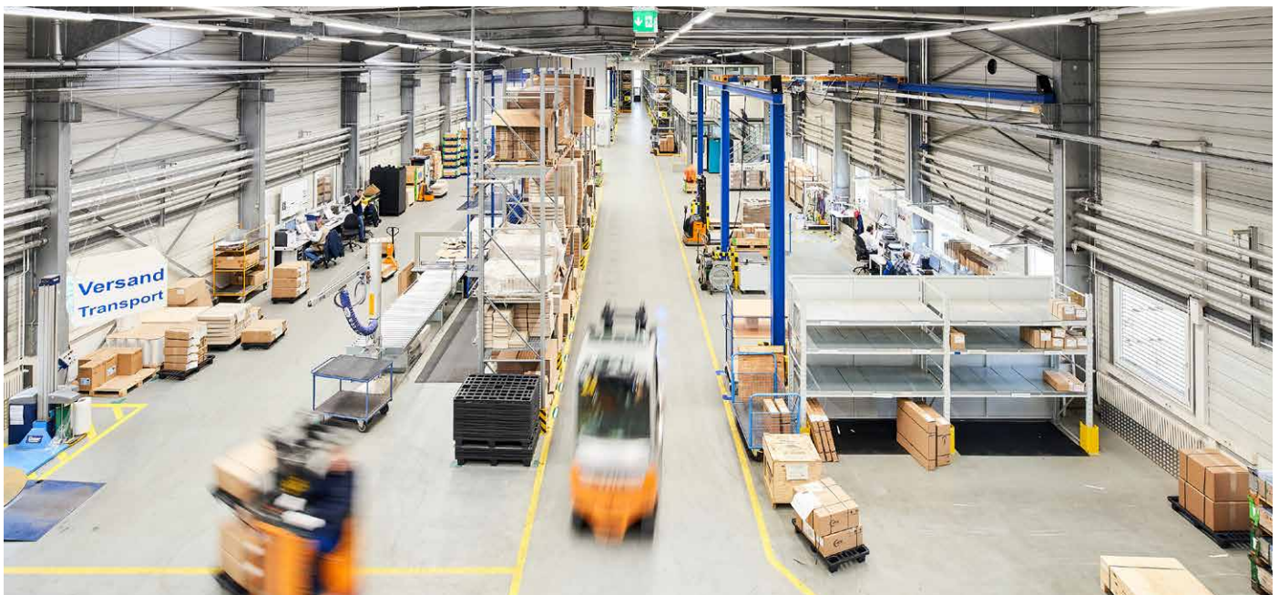
Das intelligente Transportleitsystem berechnet dynamisch in Echtzeit optimierte Abwicklungsreihenfolgen für Stapler, Elektrowägen, Hängertransporte und andere Fördermittel.
