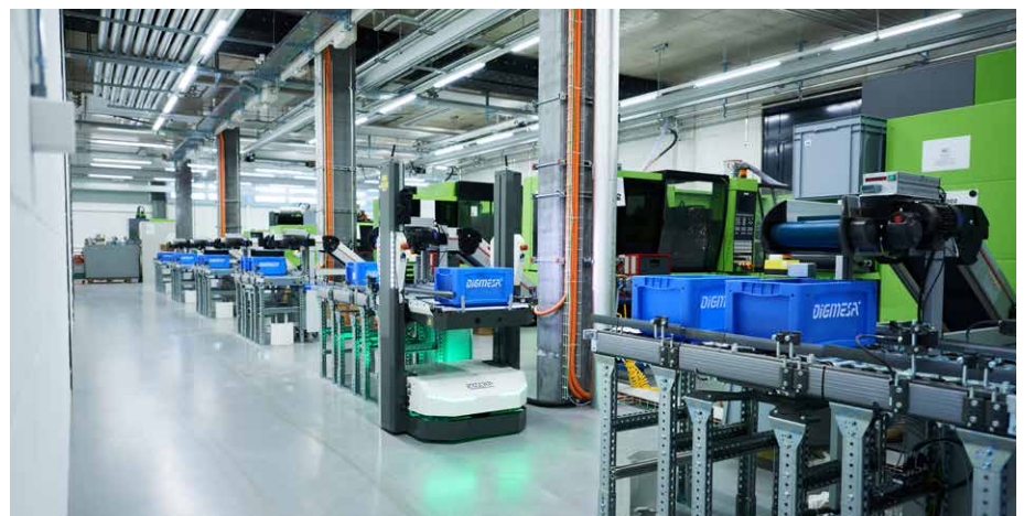
▶ Bei Digmesa versorgen die Open Shuttles die Spritzgießmaschinen mit Leerbehältern aus dem Durchlaufregal und nehmen Fertigteile wieder mit.
