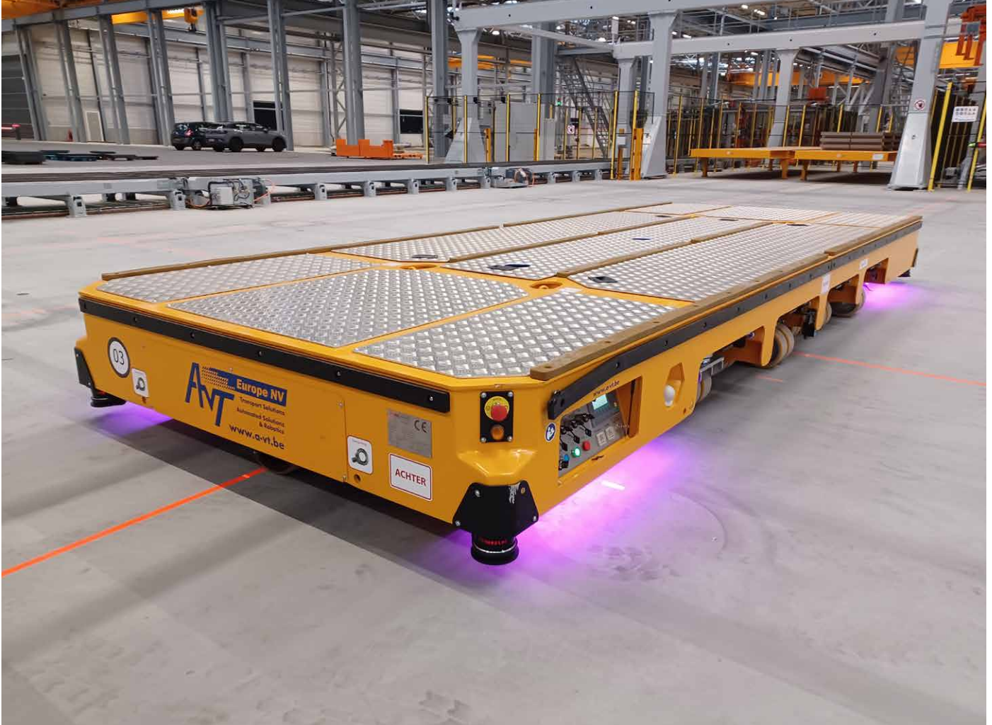
Die FTF fahren vollautomatisch und können bis zu 40 Tonnen transportieren, mehr als genug für die größten Stahlpakete.
