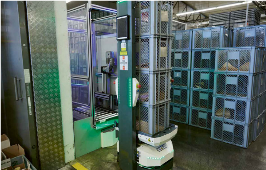
▶ PC Electric wickelt den internen Transport von Leerbehälter-Stapeln mit den Open Shuttles ab. Dank der Flottenkontroll-Software KiSoft FCS von KNAPP ist ein zentimetergenaues Andocken an der Übergabestelle möglich.
