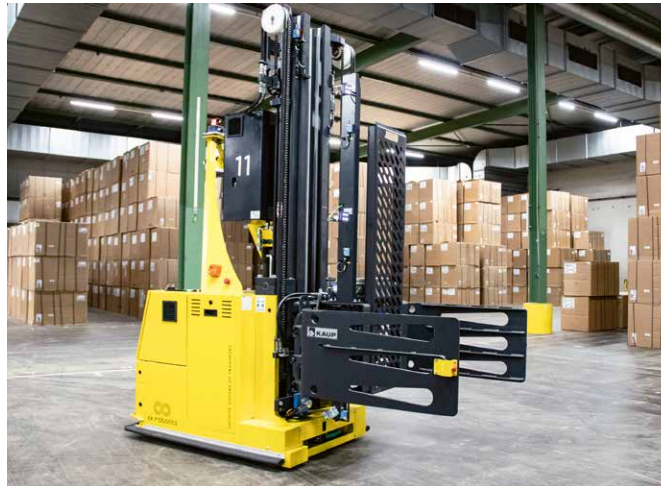
Die Ballenklammern 1T413 werden von einem namhaften Tabakwarenhersteller für das Handling von Kartons mit Rohtabak genutzt.
