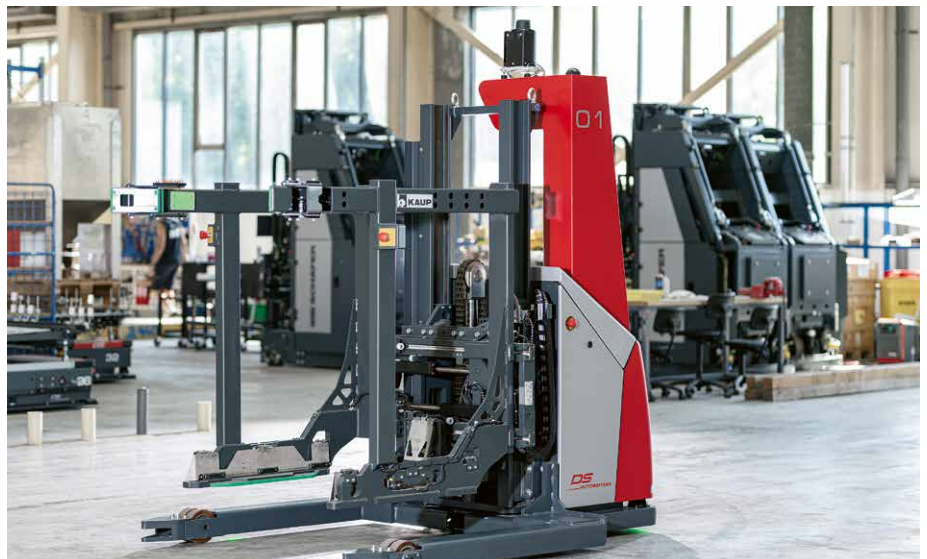
Integriertes Zinkenverstellgerät 2T160BIE mit Tragarmen in Sonderausführung
