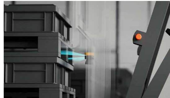
Bei der Aufnahme von Warenbehältern setzt der autonome AFi-Gabelstapler seinen unter der Gabel integrierten höhenverstellbaren 2D-Sicherheitsscanner ein.
