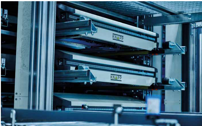
▲ Das automatische Kleinteilelager Evo Shuttle von Knapp wird Dreh- und Angelpunkt der Automatisierungslösung in der neu errichteten Produktionshalle von MSG sein.
