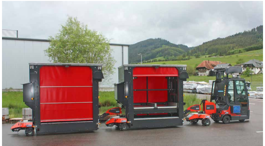
▣ Vollautomatisierter und autonomer Outdoor-Routenzug Factory Train FT620 mit Rollenbahn-Warenträger für die automatisierte Be- und Entladung.
