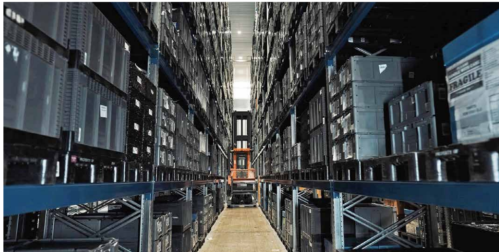
Automatisierte Schmalgangstapler vom Typ Still MX-X iGo lagern Paletten besonders platzsparend.
