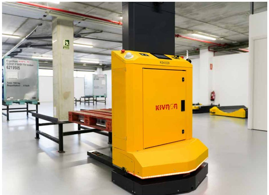
▶ Der Kivnon K55B Palettenhubwagen hat eine Tragfähigkeit von bis zu 1.200 kg.
