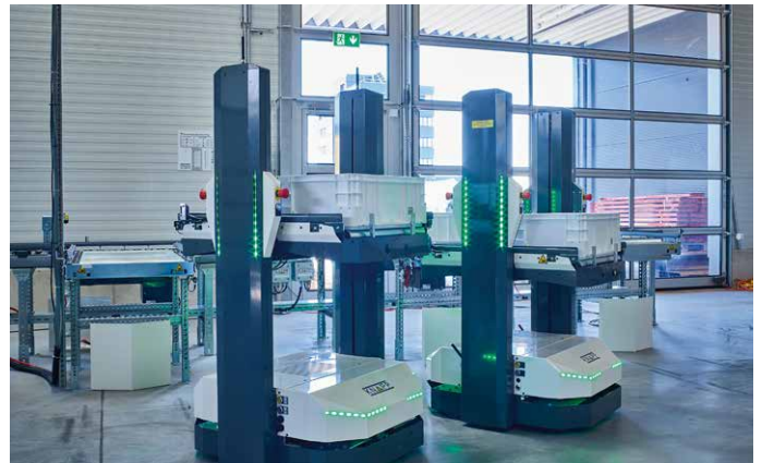
▲ Die Autonomen Mobilen Roboter Open Shuttles werden die Produktion bei MSG just-in-time und just-in-sequence versorgen.
