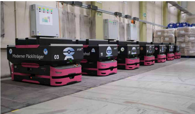
▲ Dank Schwarmintelligenz funktioniert das System ohne einen teuren Leitstand.
