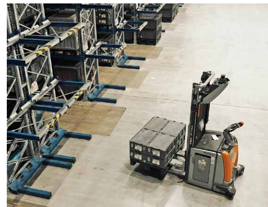
Automatisierten Hochhubwagen vom Typ Still EXV iGo bringen Paletten zu den Übernahmepunkten vor den Schmalgangregalen.
