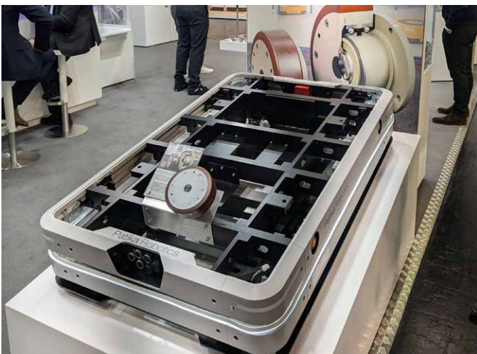
▲ Framo Morat präsentierte am SPS-Messestand Nabenge triebe für Fahrerlose Transportsysteme.
