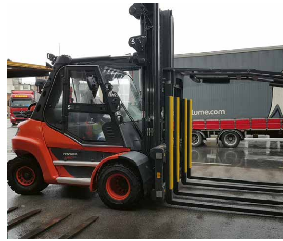
Die Mehrfachpalettengabel DPKI bei der Aufnahme von zwei mal zwei Paletten mit zusätzlichem Lasthalter.
