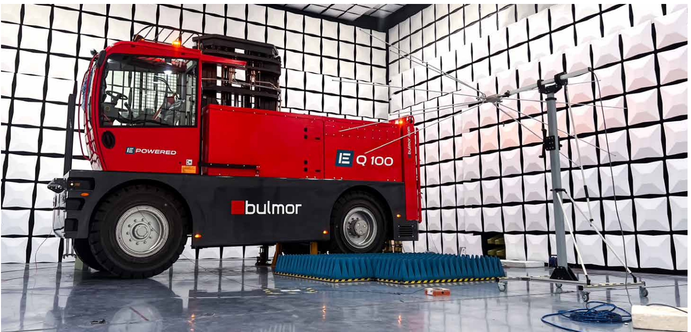
▣ HeavyLine Seitenstapler bei EMV Prüfung
