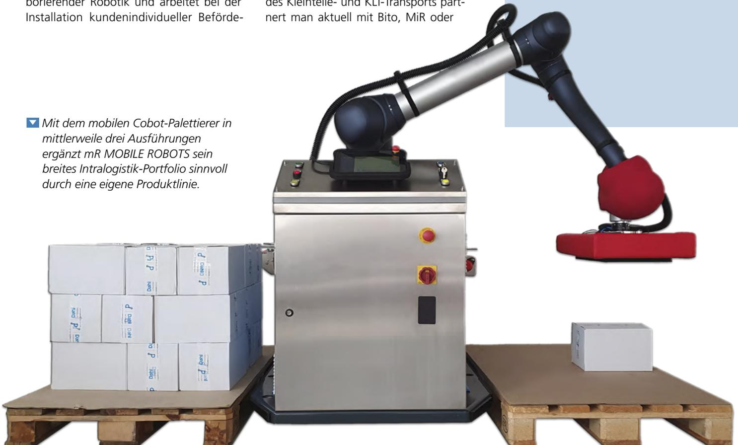
chen passend aus einem breiten Portfolio wählen und etwa den Transport auf Bodenebene ebenso bedienen wie die Regal-Einlagerung von Gütern bis zu einer Höhe von 2,5 Metern, im Individualfall auch mehr.
