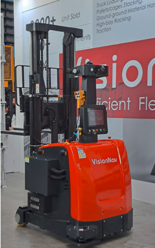
Der chinesische Hersteller VisionNav mit Europa-Zentrale in Rotterdam zeigte unter anderem den VNP20. Das Gegengewichtsstapler-AGV ist für den automatischen und flexiblen Materialtransport bei der Ein- und Auslieferung konzipiert.
