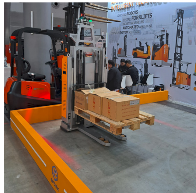
▶ Der chinesische Anbieter EFORK präsentierte unter anderem das Panda-AGV (3. Generation), das durch kompakte Maße einen kleinen Wenderadius aufweisen kann.
